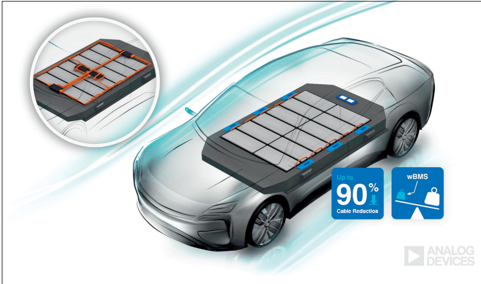
Bild 1: Das wBMS von ADI verringert den Verkabelungsaufwand in der Batterie um bis zu 90 Prozent.
